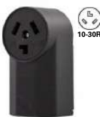
WD125 Receptáculo de potencia entrada recta 2P 3H, NEMA 10-30 30A 125/250V~
