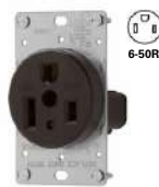
AH1254BK-BOX Receptáculo de potencia entrada recta 2P 3H, NEMA 6-50 50A 250V~
