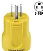
AH5965CR Clavija Resistente a la corrosión 2P 3H, NEMA 5-15 15A 125V~
