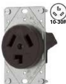
AH38BK-F Receptáculo de potencia entrada recta 3P 3H, NEMA 10-30 30A 125/250V~
