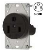
5709N Receptáculo de potencia entrada recta 2P 3H, NEMA 6-50 50A 250V~
