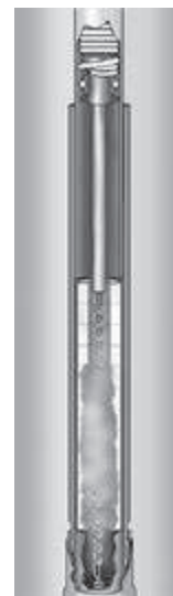
El vapor apaga el arco en el primer cero natural de corriente.
