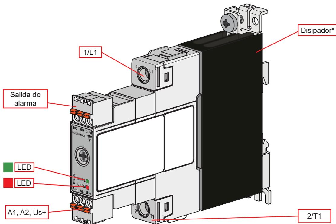
\* Disipador integrado en la versión RGC..M. La versión RGS..M no tiene disipador
