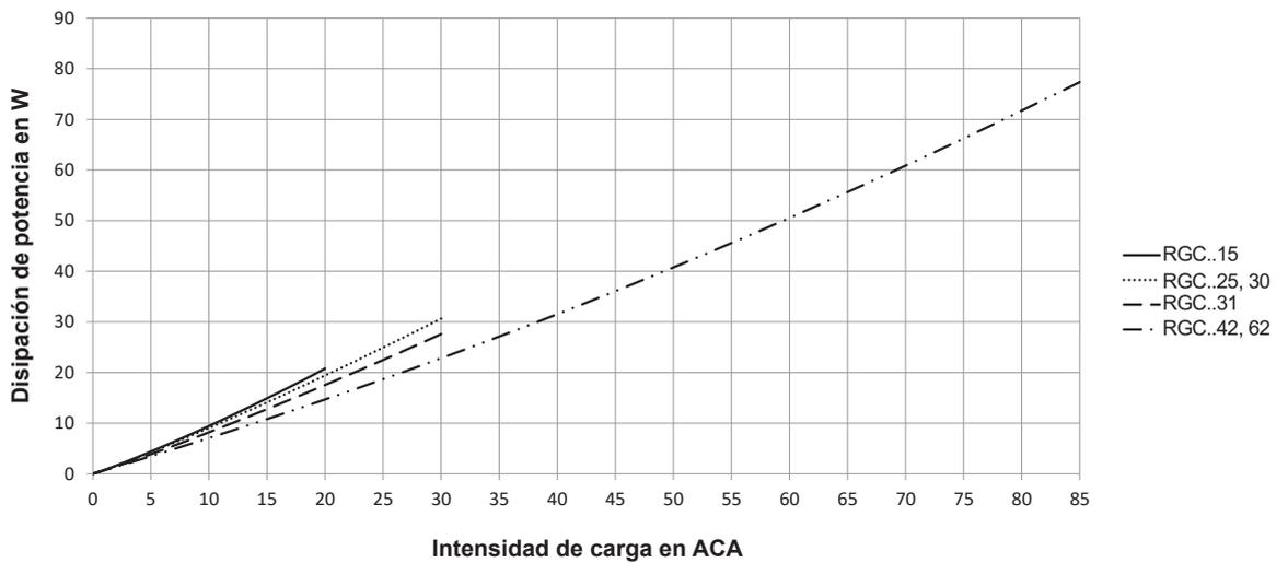
**Selección del disipador de calor para RGS..**
