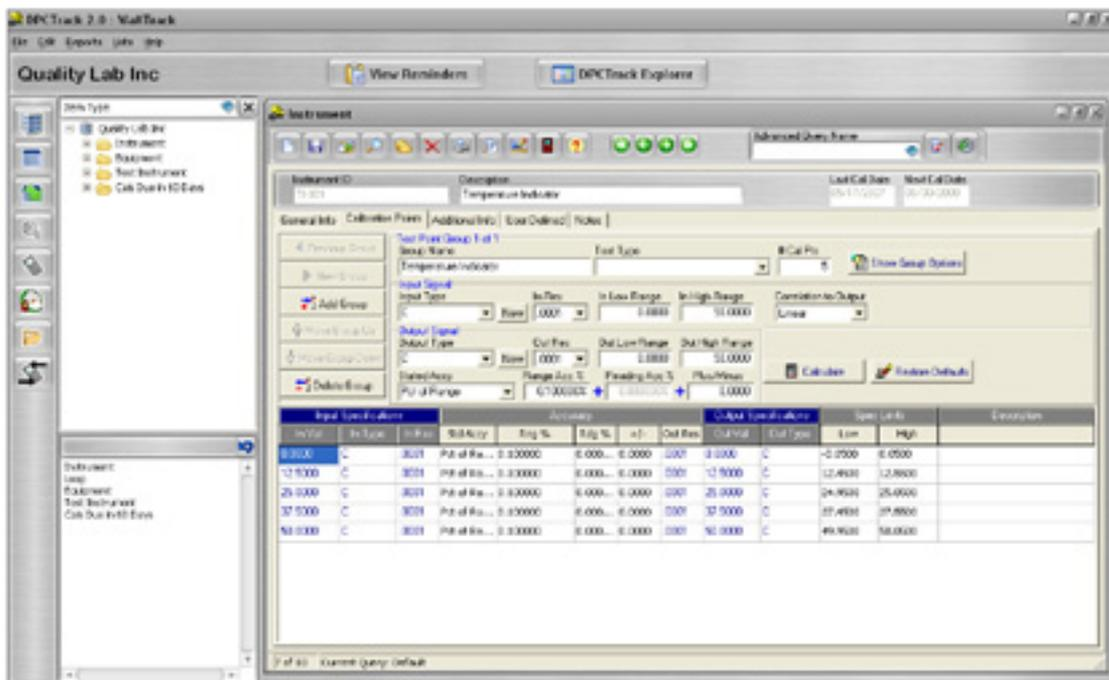
El software Fluke 750SW DPC/TRACK 2 incluye una base de datos de instrumentación que facilita la gestión de la instrumentación, la creación y programación de ensayos, carga y descarga del 753 o 754, impresión de diversos informes estándar y la gestión de los datos de calibración.
