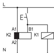
\* Admite la señal de mando (borne B1), así como el de una segunda carga: relé, telerrutor, etc., con el mismo contacto.
